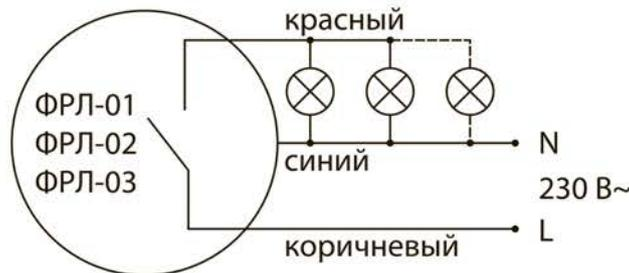
Рисунок 3. Схема подключения фотореле ФРЛ-01, ФРЛ-02, ФРЛ-03
