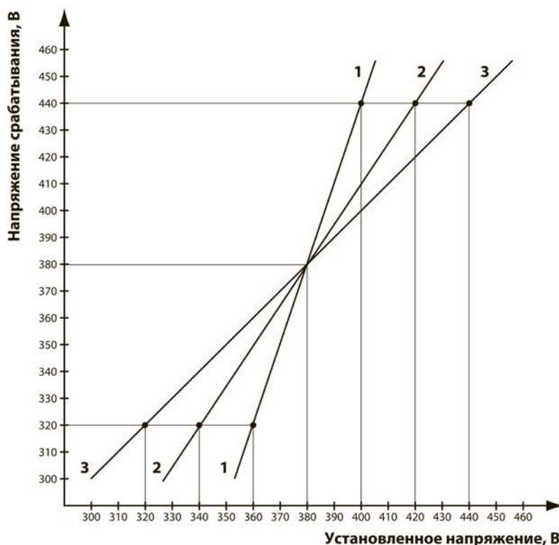
Рисунок 5. Зависимость напряжения срабатывания реле от количества фаз
