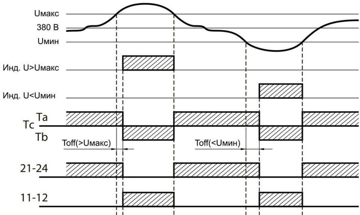
Рисунок 7. Схема работы реле ЕЛ-11М при повышении/падении межфазного напряжения
