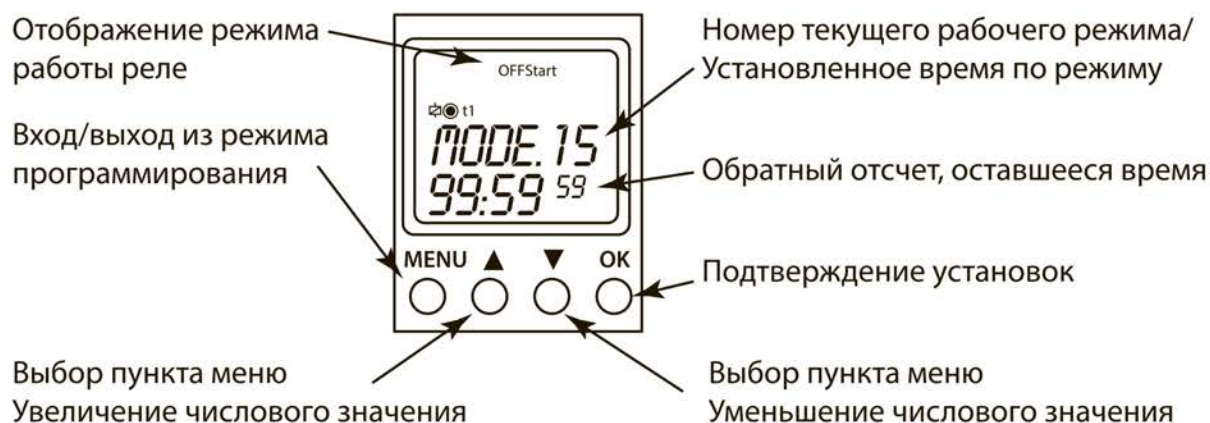
Рисунок 4. Показания дисплея и управляющие элементы реле
