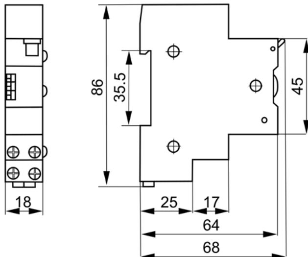
Рисунок 2. Габаритные и установочные размеры лестничного таймера ТЛ, мм
