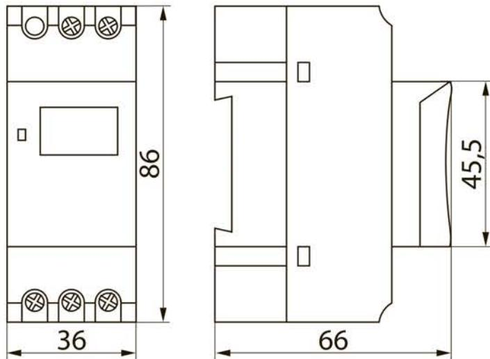
Рисунок 2. Габаритные и установочные размеры таймера ТЭ-АС, мм
