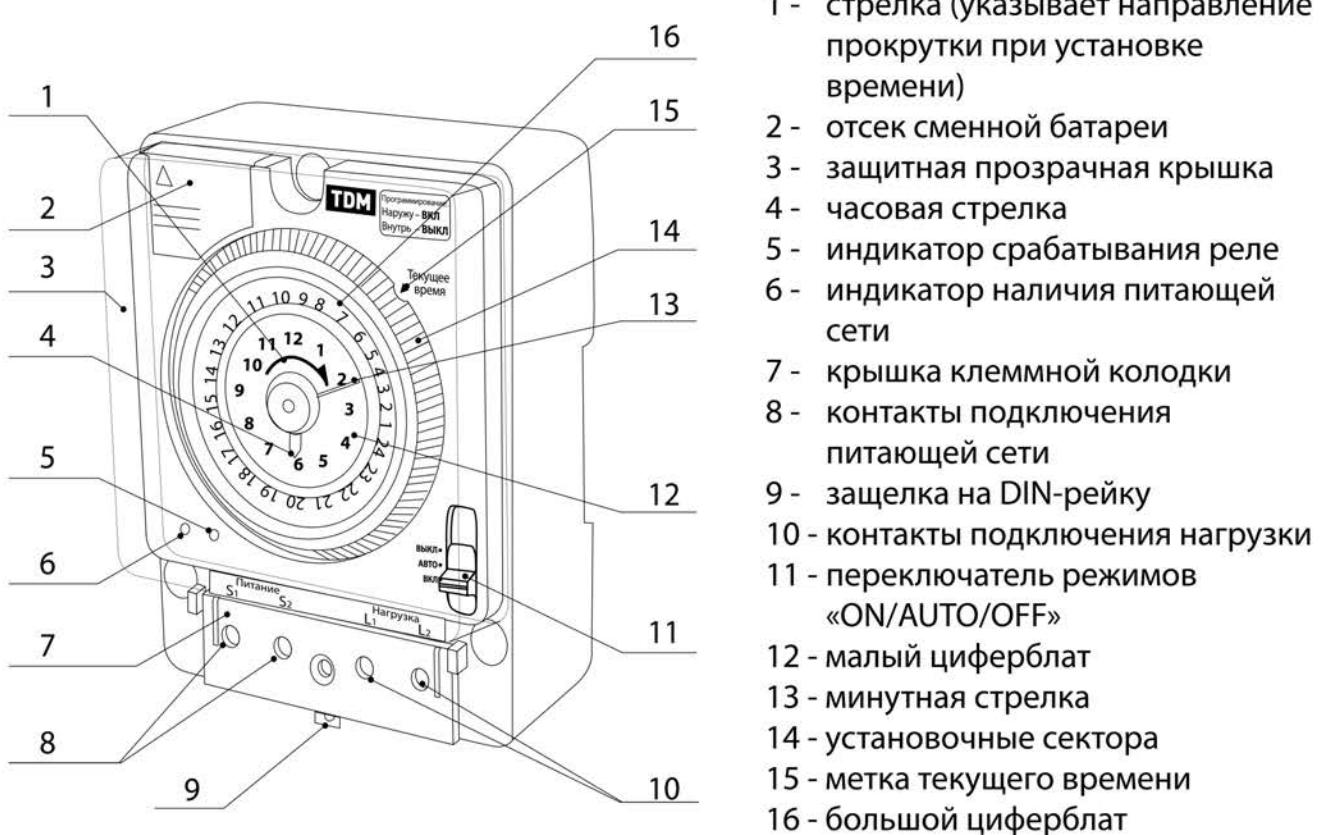
Рисунок 5. Элементы управления реле AP-П
