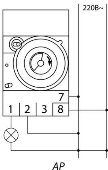
4.2. Схема подключения реле к сети в соответствии с рисунком 3.
