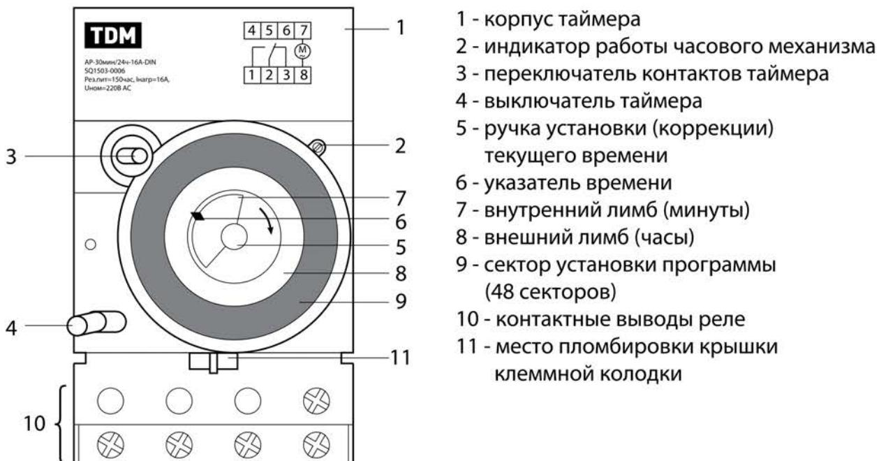
Рисунок 4. Элементы управления реле AP
