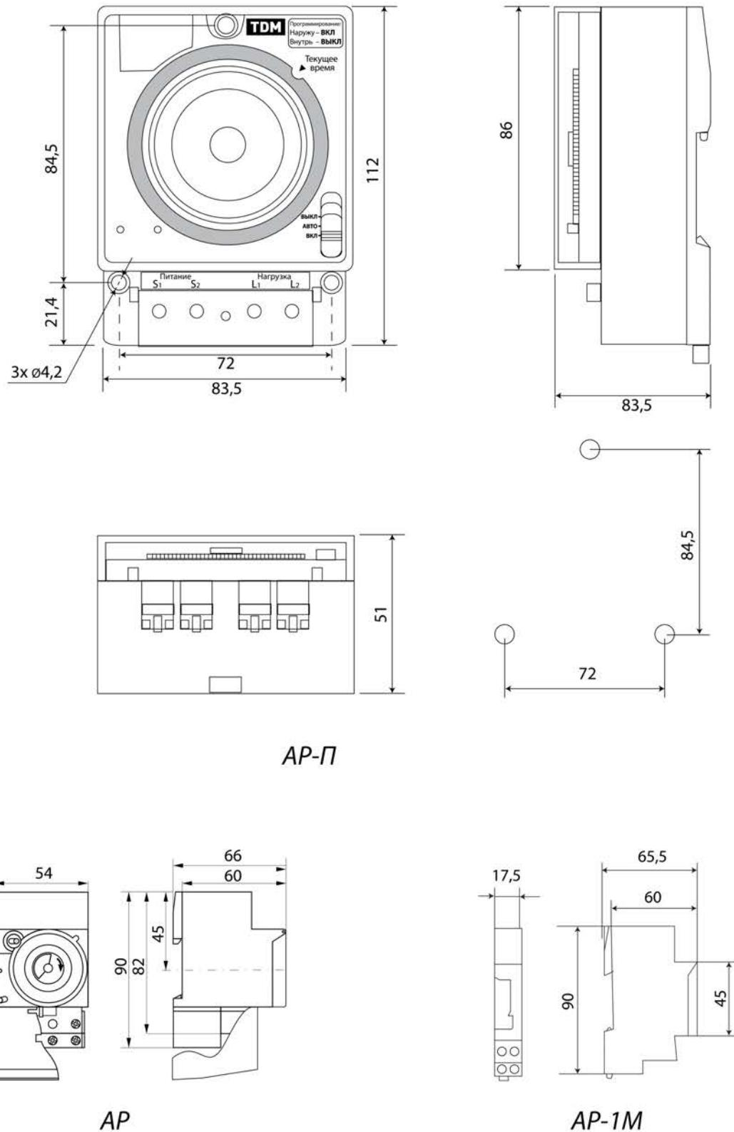
Рисунок 2. Габаритные и установочные размеры реле, мм
