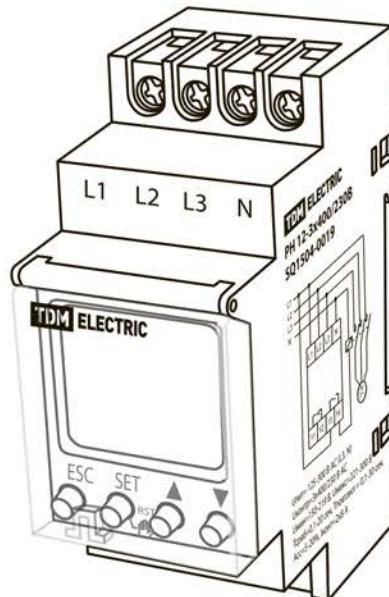
Рисунок 1. Реле контроля напряжения РН 12
