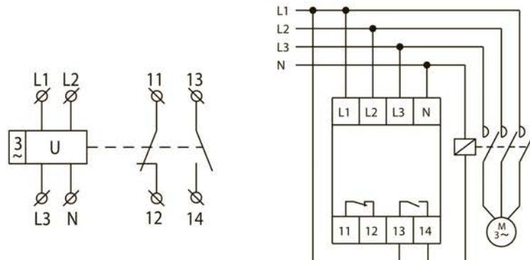
Рисунок 3. Схема подключения реле РН 12 к электрической сети
