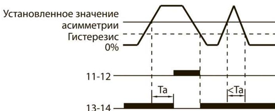
Рисунок 7. Схема работы реле РН 12 при асимметрии фаз
