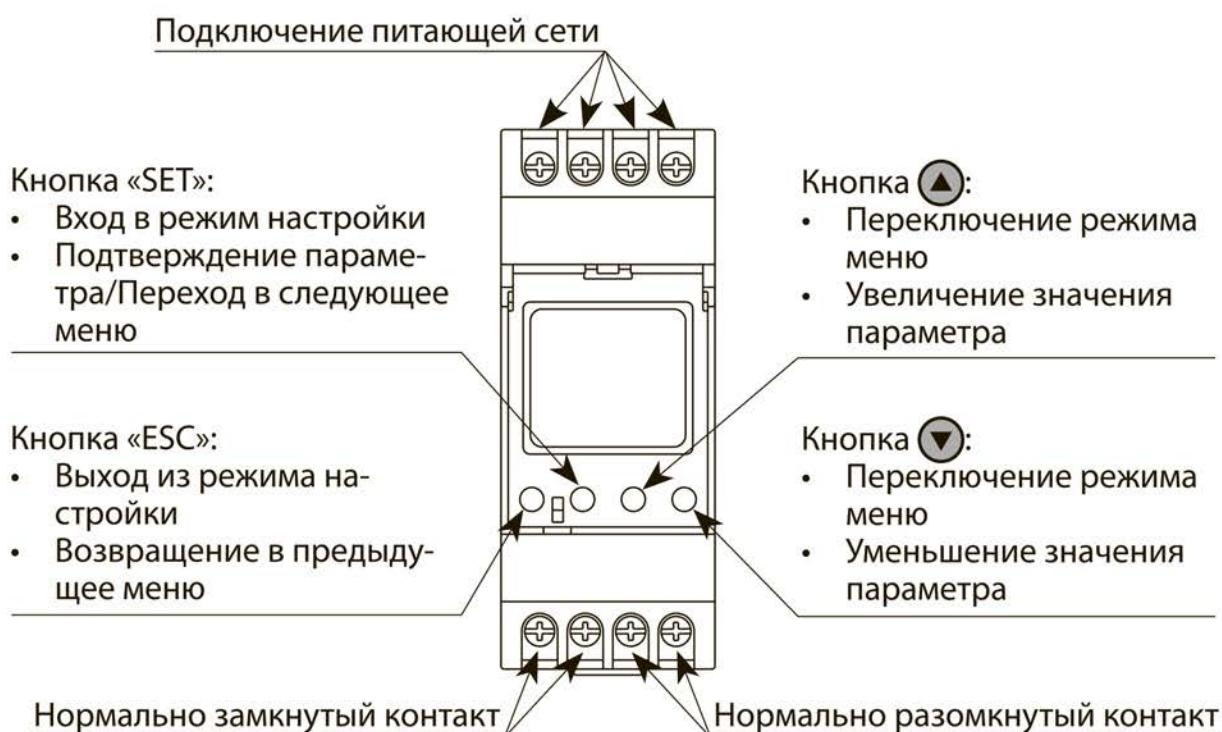
Рисунок 4. Внешний вид управляемых элементов реле PH 12
