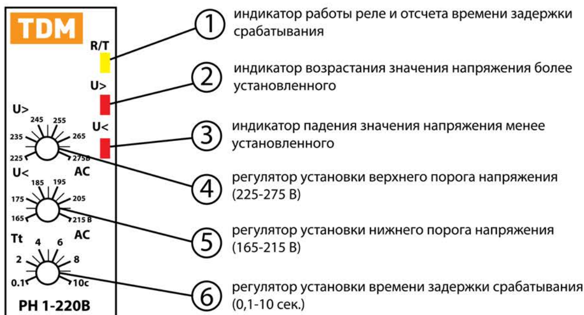
Рисунок 4. Лицевая панель реле PH 1
