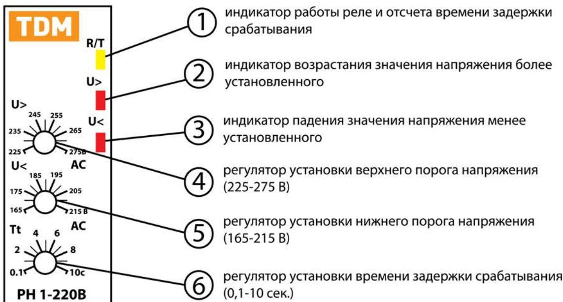
Рисунок 4. Лицевая панель реле РН 1
