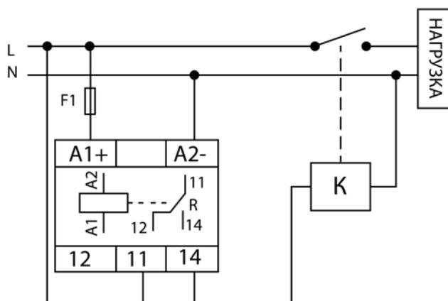
Рисунок 3. Схема подключения реле PH 1 к электрической сети
