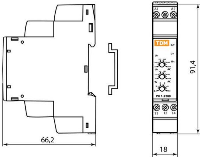
Рисунок 2. Габаритные и установочные размеры реле напряжения серии РН 1, мм
