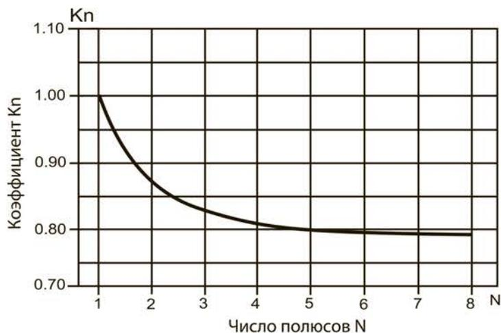
Рисунок 2. График зависимости коэффициента  $K_n$  от числа полюсов
