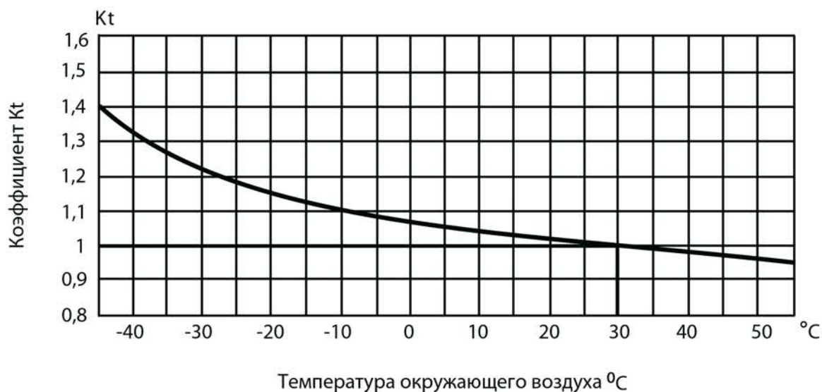
Рисунок 3. Определение коэффициента K_t
