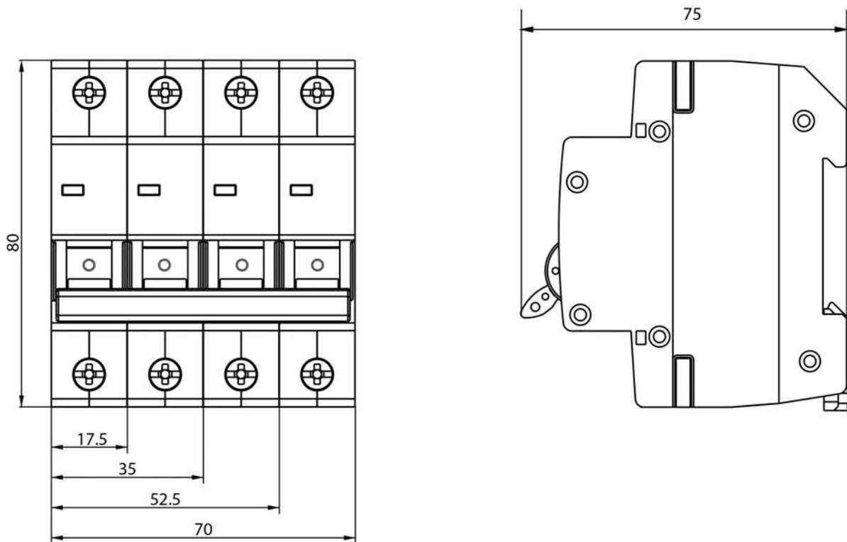
Рисунок 4. Габариты и установочные размеры, мм
