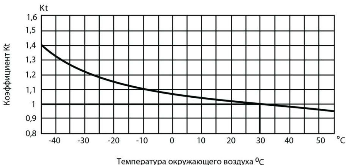
Рисунок 3. Определение коэффициента  $K_t$
