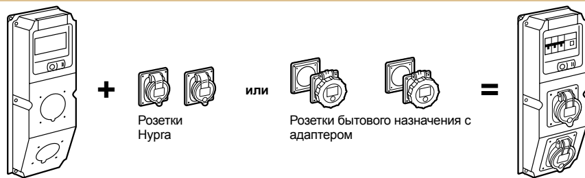
Щиток с отверстиями
