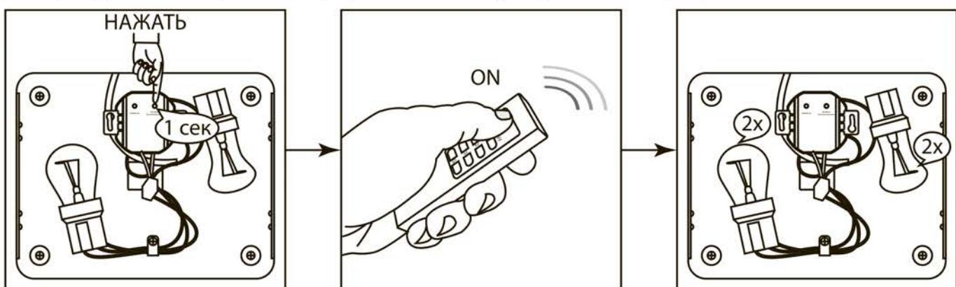
Рисунок 7. Пример подключения пультов ПУЗ, ПУБ к приемнику M1.
