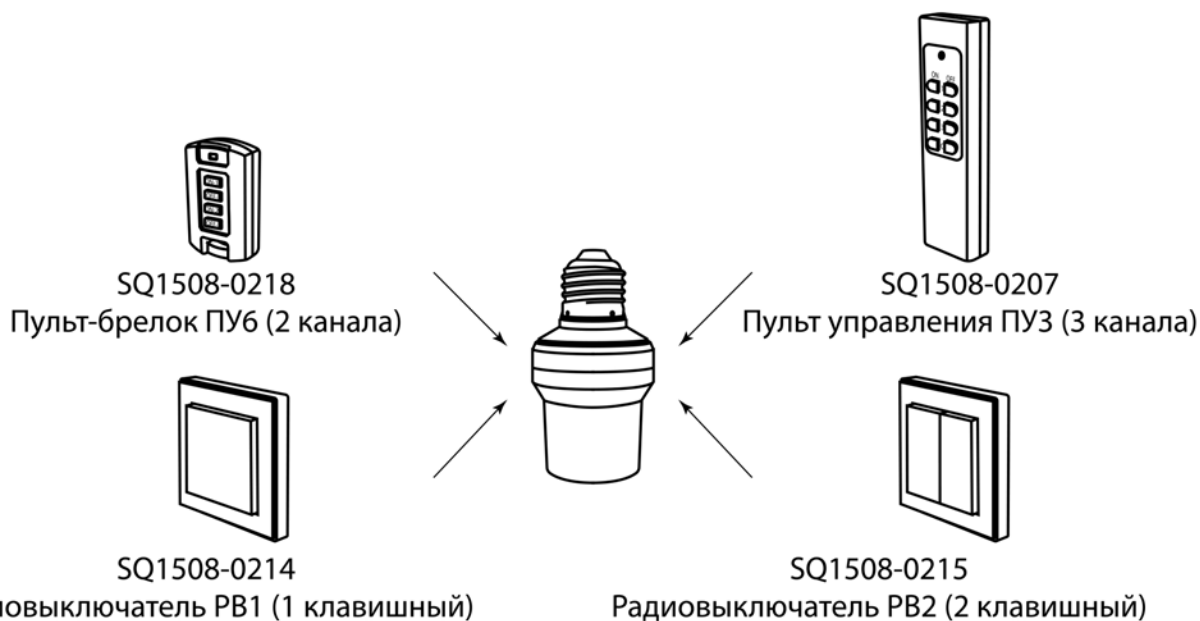
Рисунок 3. Подключение приемников П1-Е27 к пультам и радиовыключателям
