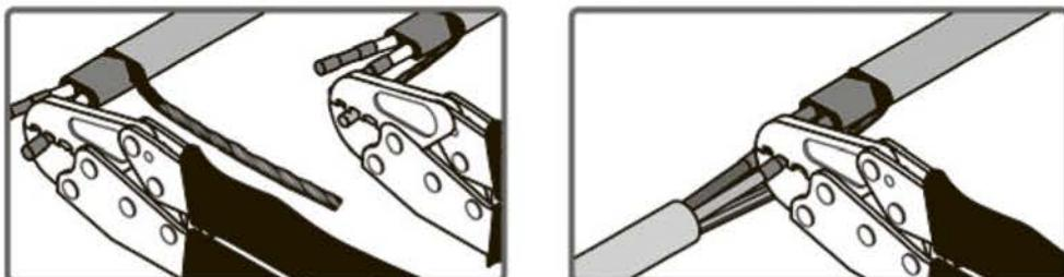
7. Надвинуть черную kleевую термоусадку  $d=24$  мм, длиной 100 мм так, чтобы она полностью закрывала места соединений саморегулирующегося и сетевого кабеля и термоусадить ее; далее сверху надвинуть черную kleевую термоусадку  $d=24$  мм, длиной 200 мм и термоусадить ее с помощью промышленного фена. Нагревать трубку необходимо с середины к краям, чтобы внутри не образовался пузырь воздуха.
