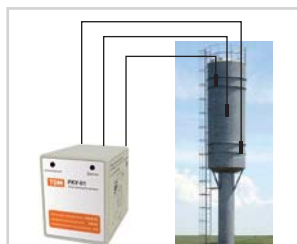
Автоматический контроль уровня воды в водонапорной башне.
