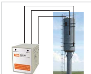
Автоматический контроль уровня воды в водонапорной башне.
