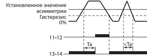
Схема работы реле PH 12 при асимметрии фаз.
