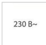
**Номинальное напряжение** – напряжение переменного тока (знак ~), при котором аппарат работает в нормальных условиях.
