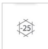
Этот специальный знак означает, что дифференциальный автомат способен работать при температуре до **-25 °С**.
