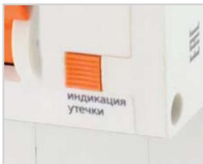
В блоке дифференциальной защиты предусмотрена **кнопка «индикация утечки»**, которая в случае срабатывания аппарата по дифференциальному току, механически препятствует повторному включению аппарата без ручного возврата ее в корпус.
