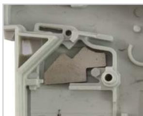
Под антипригарной пластиной находится **постоянный магнит**. Он ориентирует магнитное поле внутри автоматического выключателя таким образом, чтобы дуга при разъединении силовых контактов затягивалась в дугогасительную камеру.
