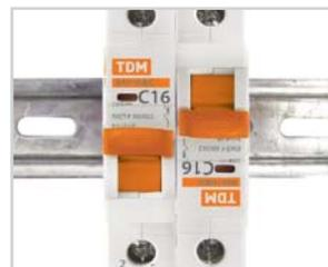
Выключатели BA47-29 **могут устанавливаться в любом положении** без изменения их номинальных характеристик. Подвод питающей линии может производиться как через верхние, так и через нижние клеммы без нарушения работоспособности автомата.
