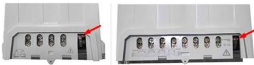
Рисунок 4.2 – Расположение переключателя блокировки управления нагрузкой счетчиков «Меркурий 208» (слева) и «Меркурий 238» (справа)
