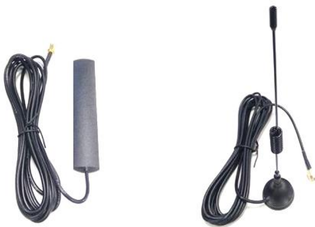
Рисунок 5.2 – «Лепестковая» (слева) и «штыревая» (справа) антенны
