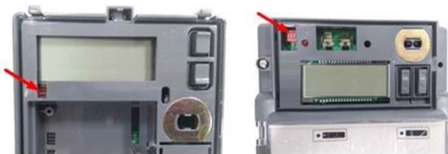
Рисунок 4.1 – Расположение переключателя блокировки управления нагрузкой счетчиков «Меркурий 204» (слева) и «Меркурий 234» (справа)
