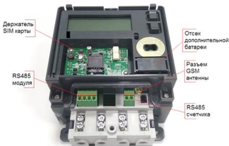
Рисунок 5.3 Вид счетчика «Меркурий 204» с элементами подключения
