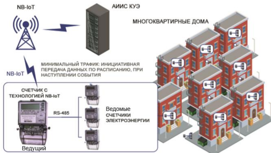
Рисунок 4.4 – Схема работы счетчика NBIOT в составе АИИС КУЭ
