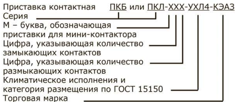
Рисунок 1 – Структура условного обозначения приставок контактных
