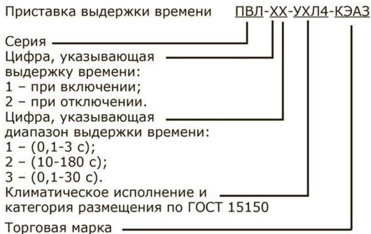
Рисунок 2 – Структура условного обозначения приставок выдержки времени
