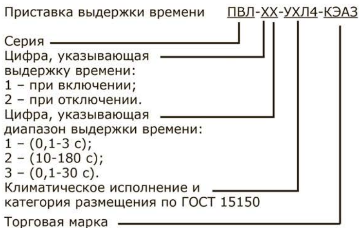
Рисунок 2 – Структура условного обозначения приставок выдержки времени
