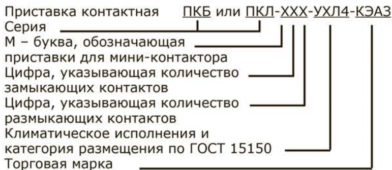
Рисунок 1 – Структура условного обозначения приставок контактных
