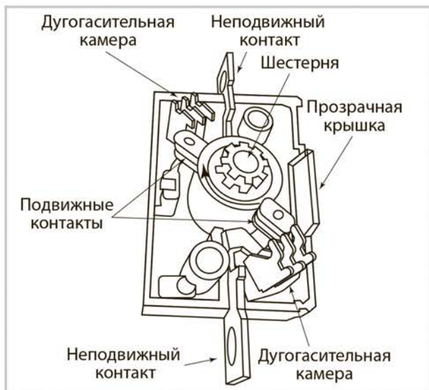
Рисунок 2. Конструкция полюсного блока
