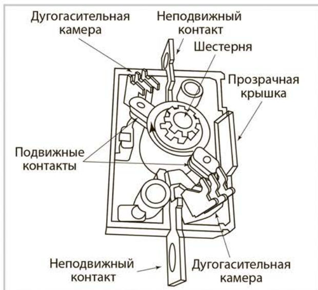
Рисунок 2. Конструкция полюсного блока
