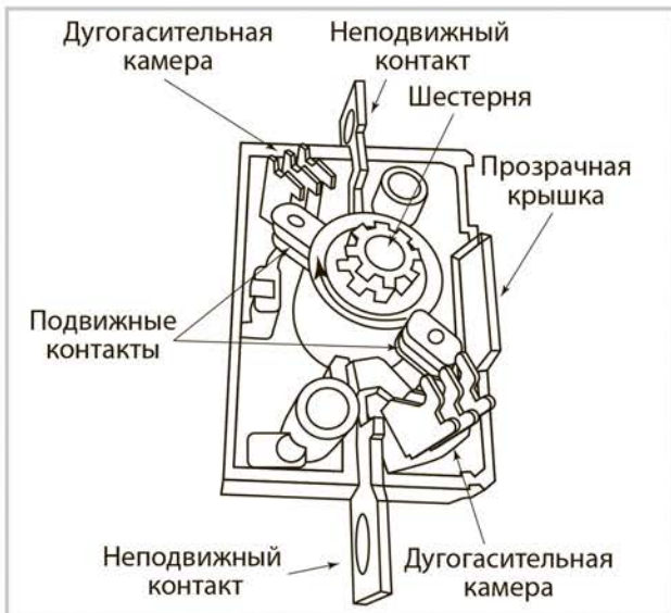
Рисунок 2. Конструкция полюсного блока
