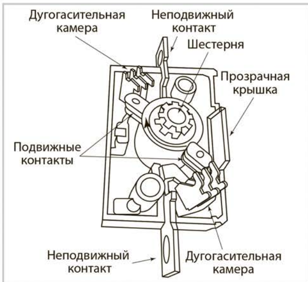
Рисунок 2. Конструкция полюсного блока
