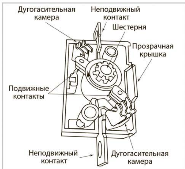
Рисунок 2. Конструкция полюсного блока
