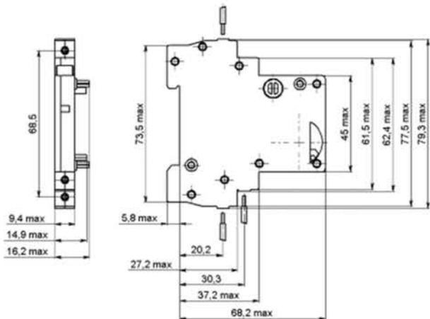
Рисунок 1 – Габаритные размеры МВК
