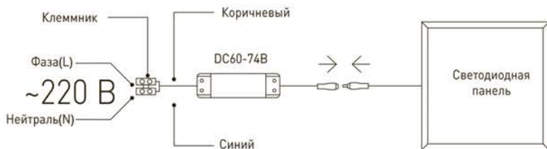
Рис.1. Схема подключения светодиодной панели к сети 220В.
