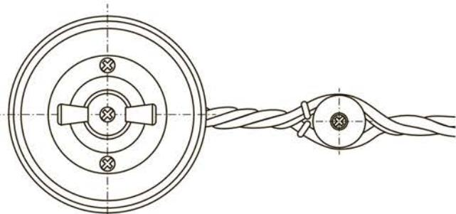
3.10. Установить корпус выключателя (розетки) и закрепить его при помощи крепежных саморезов.
