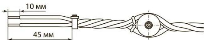
3.5. Обрезать проводники провода на расстоянии 45 мм от хомута. Очистить свободные концы проводников от изоляции на величину 10 мм.
