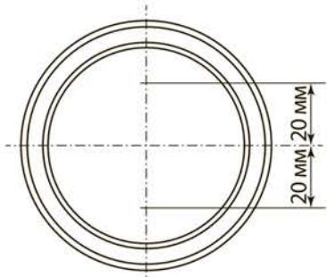
3.1. Определить и отметить центр местоположения выключателя (розетки) на стене. Разметить места под крепежные саморезы на расстоянии 20 мм от центра местоположения выключателя (розетки).
