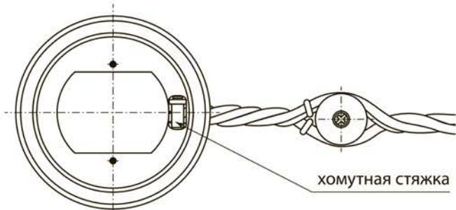
3.8. Установить основание выключателя (розетки) таким образом, чтобы хомутная стяжка, закрепленная на проводе, оказалась внутри него.
