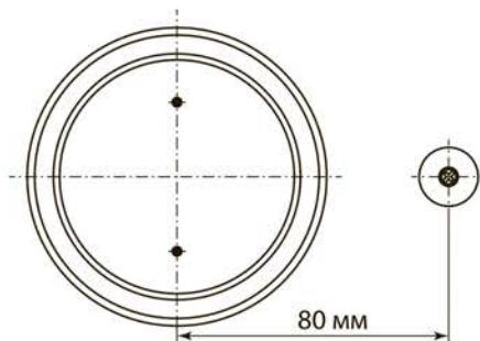
3.2. Определить и отметить место расположения изолятора, на котором будет крепиться подводящий провод (80 мм). Закрепить изолятор.
