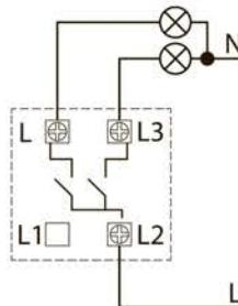
Рисунок 2. Схема подключения двухклавишного выключателя.
