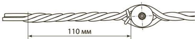
3.3. Закрепить провод на изоляторе (свободный конец провода должен составлять не менее 110 мм).
