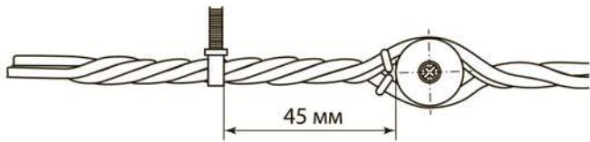
3.4. На расстоянии 45 мм от изолятора на подводимом проводе закрепить провод хомутом.
