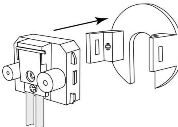
Рисунок 6. Вставить в суппорт электрическую часть розетки.
