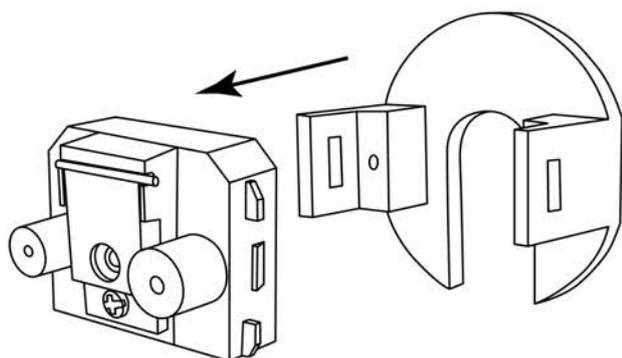
Рисунок 3. Извлечь электрическую часть из пластикового суппорта.
