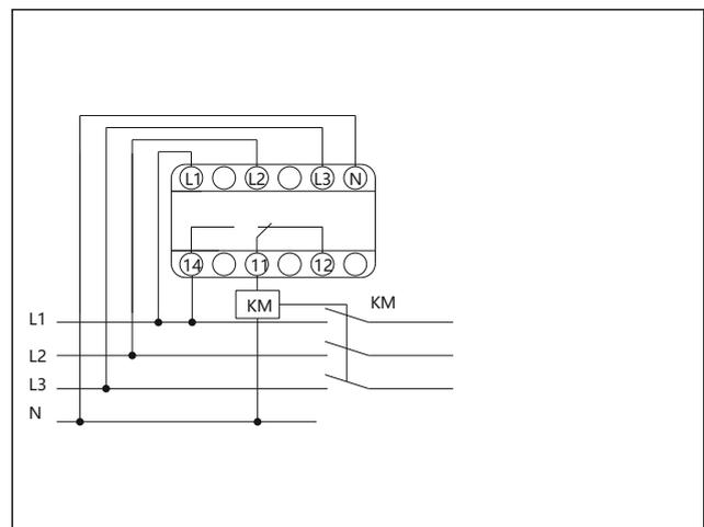
Электрическая схема NJYB3-9, NJYB3-10, NJYB3-11
