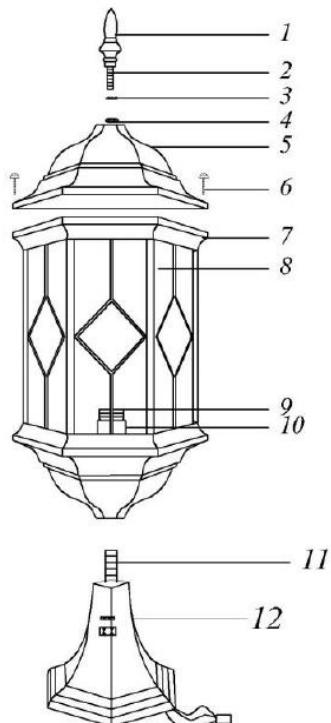
1 – балюсина; 2 – резьбовое крепление; 3 – гровер; 4 – гайка; 5 – верхняя крышка; 6 – винты; 7 – каркас; 8 – стеклянный рассеиватель; 9 – патрон; 10 – ламподержатель; 11 – резьбовое крепление; 12 – постамент; 13 – гайка декоративная.
