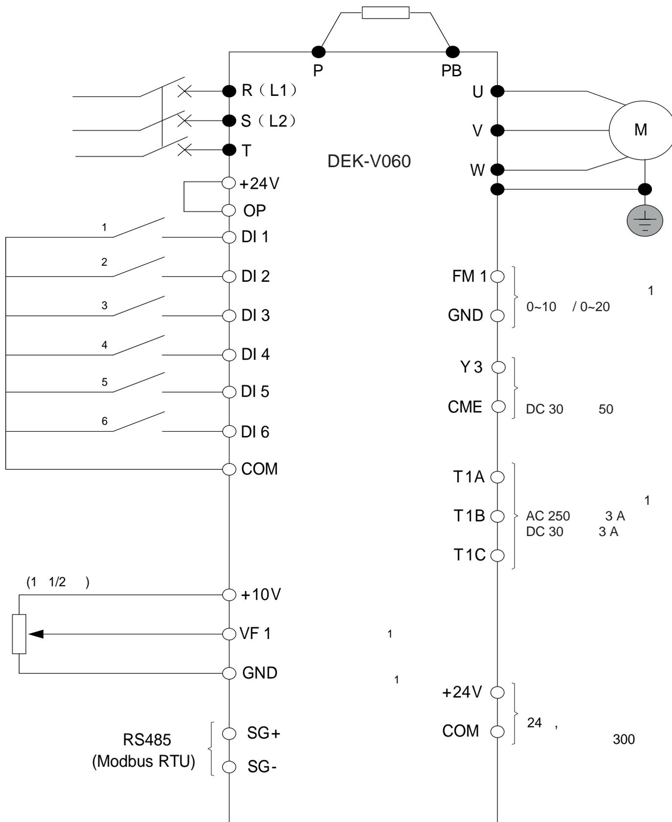
**Примечание:** данная схема подключения применяется как для ПЧ с однофазным входом 220 В (L1, L2), так и для ПЧ с 3-фазным входом 380 В (R, S, T).
