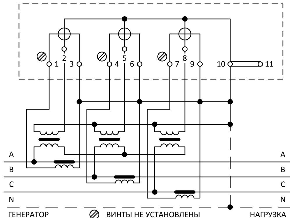
**Рисунок Б.6 – Схема подключения счетчика «Меркурий 234», включение через три трансформатора напряжения и три трансформатора тока**
