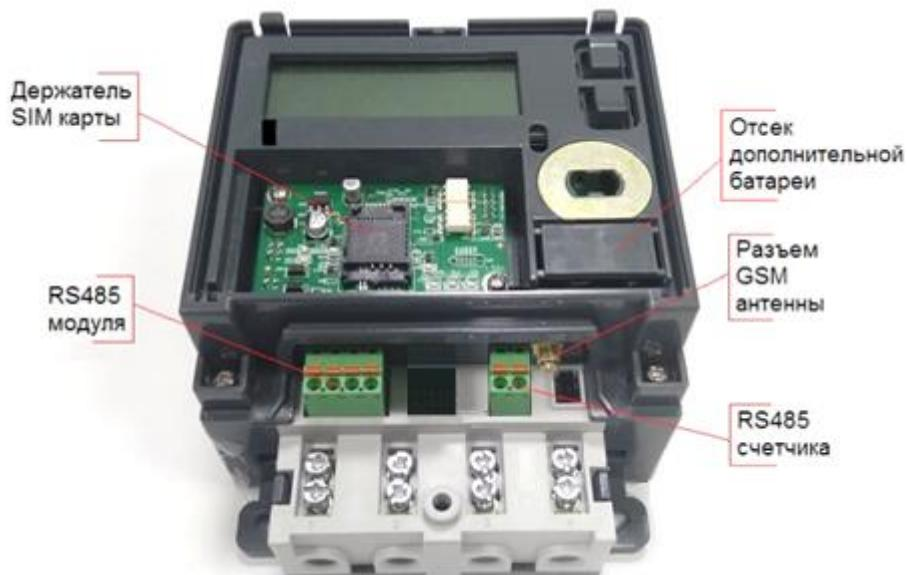
**Рисунок 5.3 Вид счетчика «Меркурий 204» с элементами подключения**
