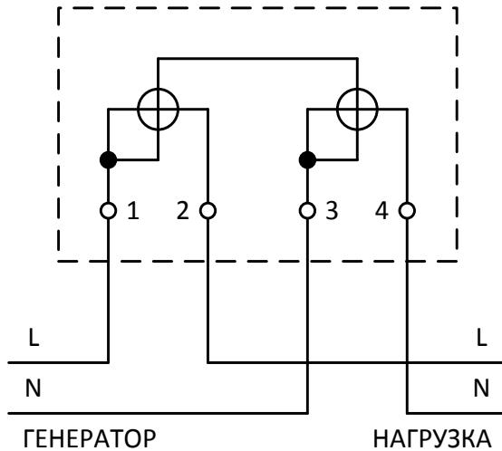
**Рисунок Б.1 – Схема подключения счетчиков «Меркурий 204»,
