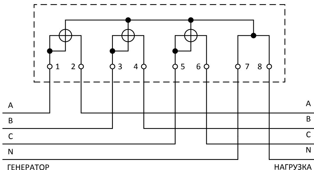
**Рисунок Б.2 – Схема подключения счетчика «Меркурий 238»,
