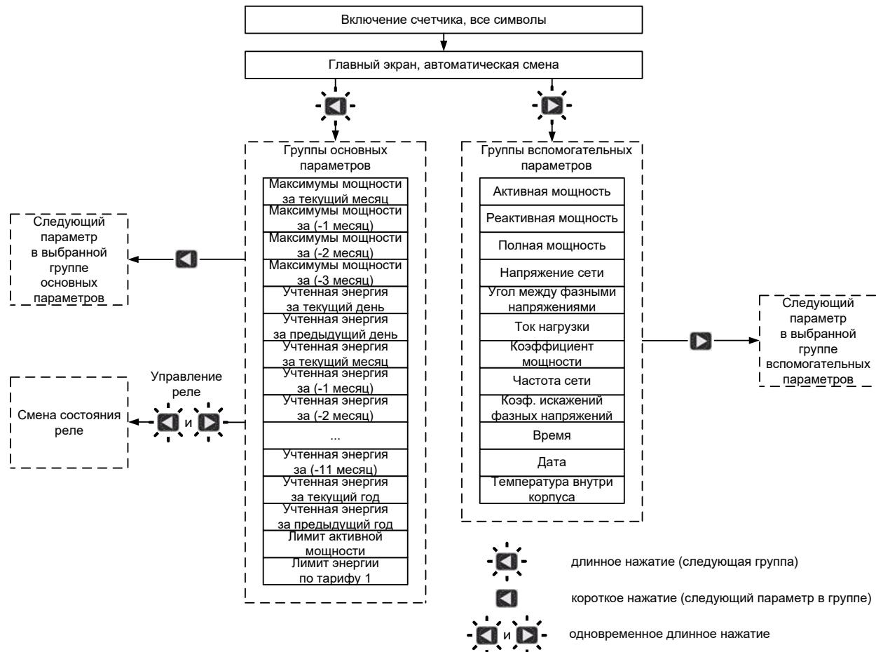
**Рисунок 5.8 – Режимы индикации и переходы между ними**
