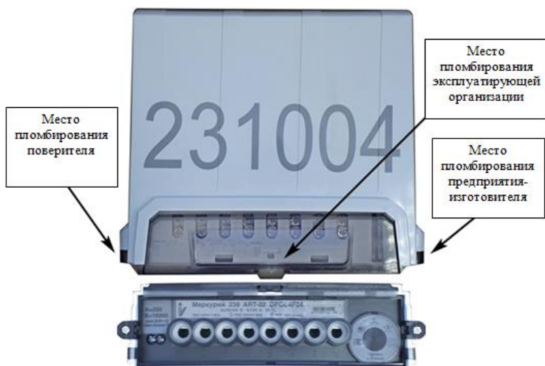
Рисунок 3.4 – Общий вид счетчиков «Меркурий 238» с указанием мест пломбирования и нанесения знака поверки
