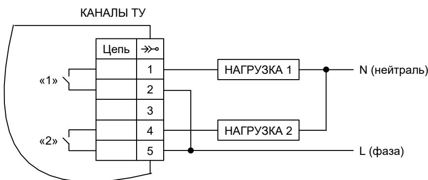
**Рисунок Б.15 – Схема подключения дискретных выходов счетчика «Меркурий 234» с функциями телемеханики**
