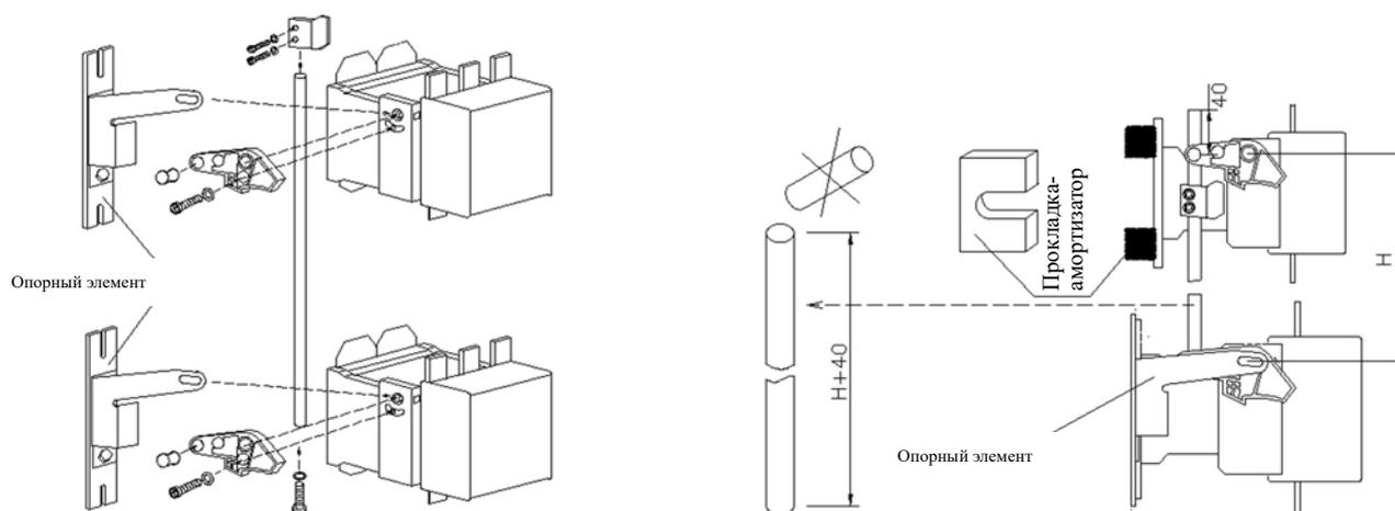
Примечание: 1. Для вертикального монтажа установите изделие с меньшим током сверху; по окончании установки, если длина соединительного стержня достигает  $H+40$ , пользователь может отрезать лишнюю часть стержня сверху (см. рисунок 7).
