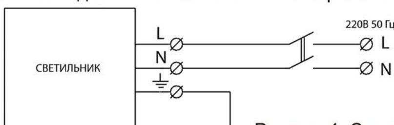
Рисунок 1. Схема подключения светильника.
