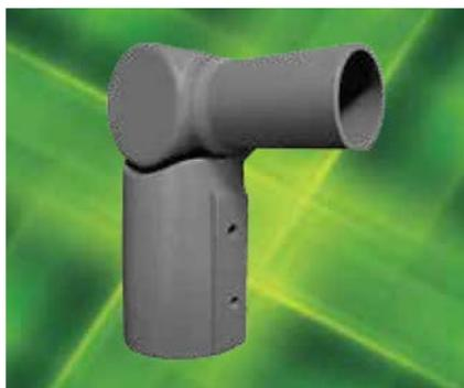
Поворотный кронштейн для уличных светильников предназначен для установки светильника под углом 90°. Выполнен из высокопрочного материала, надежно фиксирует угол наклона благодаря торцевому зубчатому зацеплению. Устойчив к высоким и низким температурам. Поставляется в комплекте с болтами.
