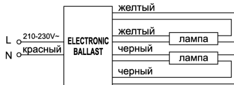
Рис. 3 Схема подключения ЭПРА EB53
