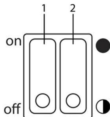
1 - клавиша в положении **On** включает режим половинной тепловой мощности завесы. При этом включаются электронагреватели, загорается подсветка клавиши.
