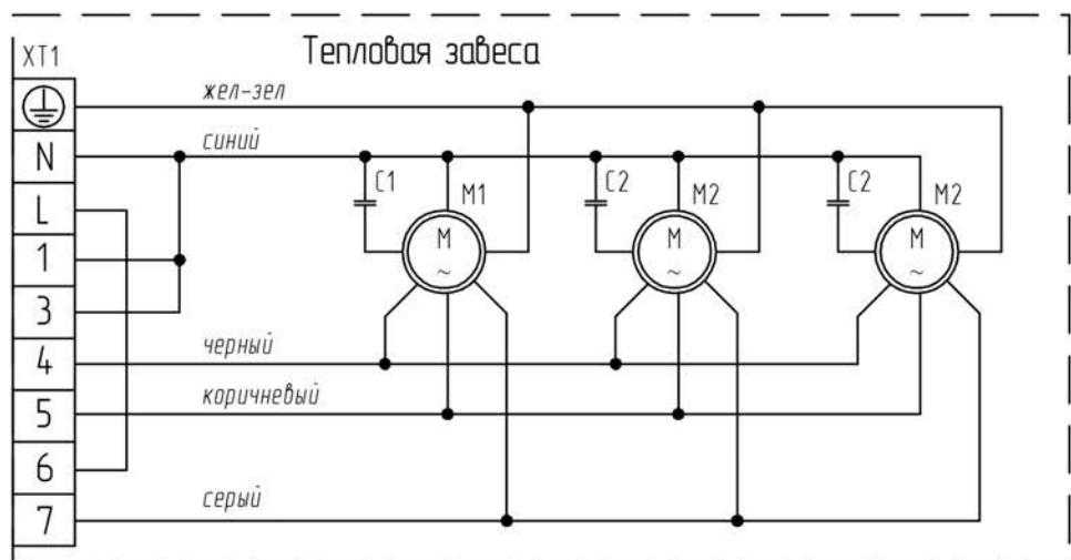
**Схема электрическая принципиальная BHC-U15A-PS, BHC-U20A-PS, BHC-U15W40-PS, BHC-U20W55-PS с подключением контроллера (пульта) BRC-W**
