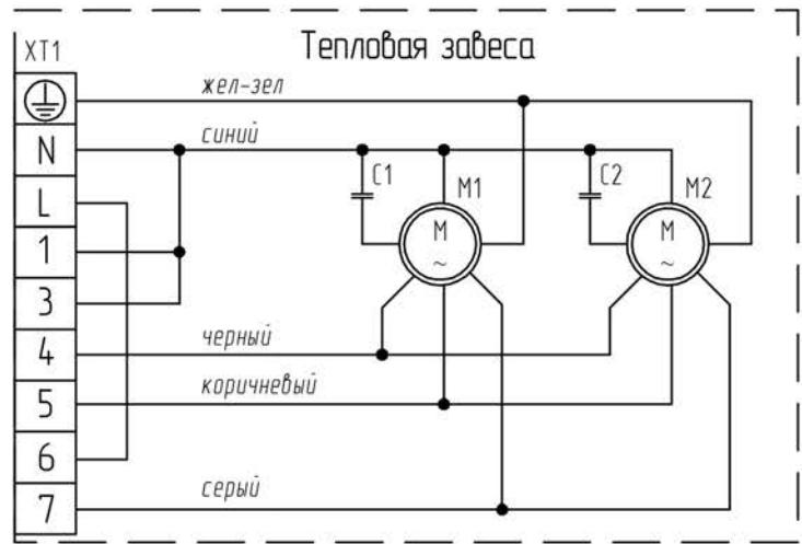
**Схема электрическая принципиальная ВНС-U20A-PS и ВНС-U20W55-PS**
