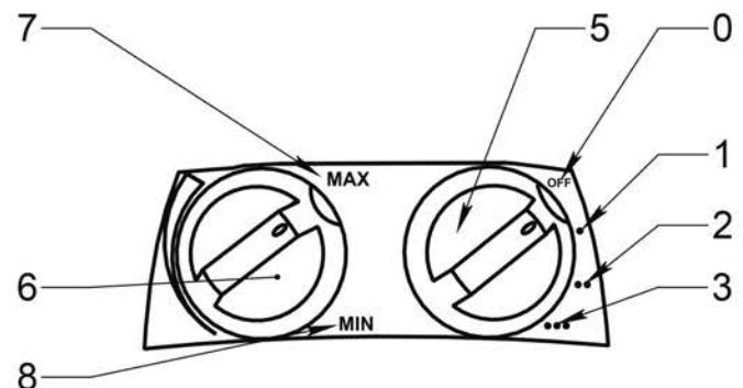
1) Перед подключением прибора к электросети переведите ручку переключателя (5) в положение режима «0». Затем подключите тепловентилятор к электросети (включите вилку шнура питания в розетку с напряжением 220 В / 50 Гц и заземляющим проводом). Прибор готов к работе.
