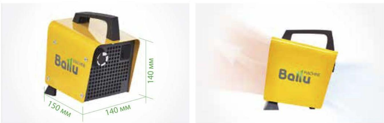
Металлокерамические нагревательные элементы Ballu имеют свойство автоматической терморегуляции. Чем выше их температура, тем больше электрическое сопротивление, меньше потребляемая мощность и меньше нагрев. Это исключает перегрев и обеспечивает высокую экономичность расхода электроэнергии.
