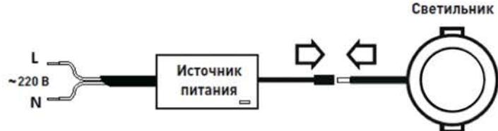
Рис.1. Подключение светильника к сети переменного тока 220В.
