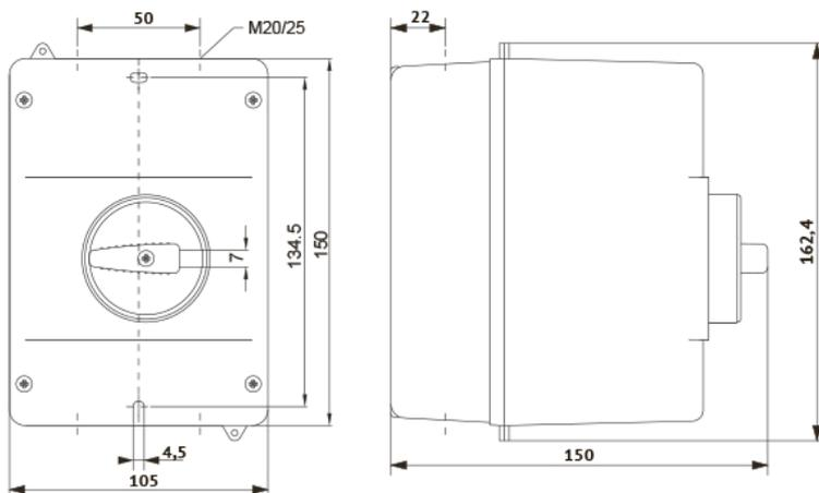
Механизм поворотный на дверь
