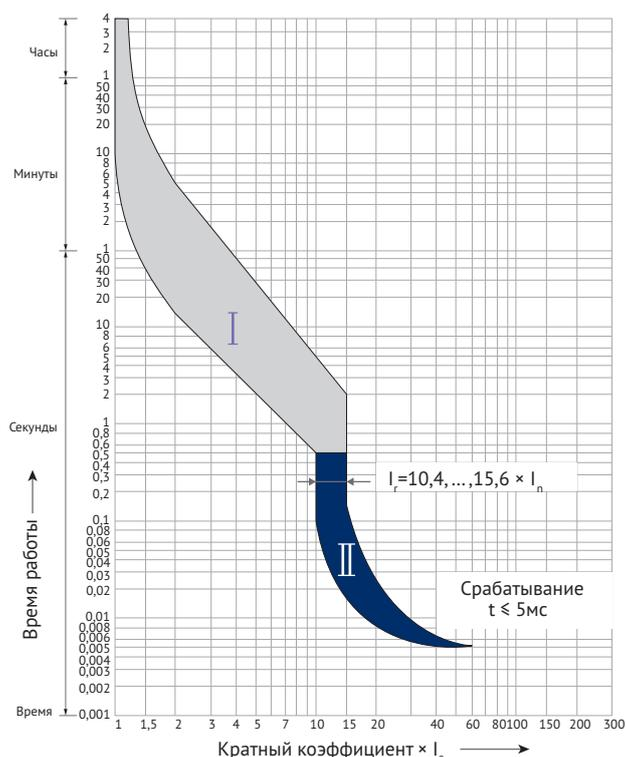
Зона I – время-токовая характеристика срабатывания расцепителя токов перегрузки (теплового расцепителя) из холодного состояния при температуре окружающей среды 20°C.
