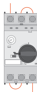
Подключение однофазного двигателя
